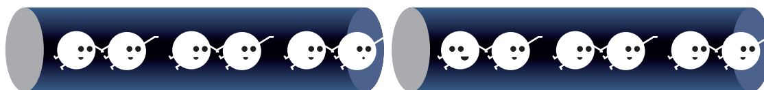
När ett material blir supraledande kopplar elektronerna ihop sig två och två i Cooperpar , och strömmar då utan motstånd. Luckan i bilden markerar Josephsonövergången.
